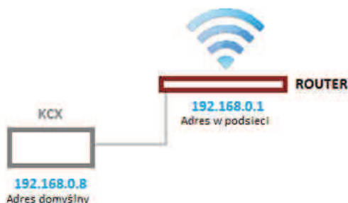
Rys. Nr 19 Bezpośrednia komunikacja ze sterownikiem przez Router WIFI
