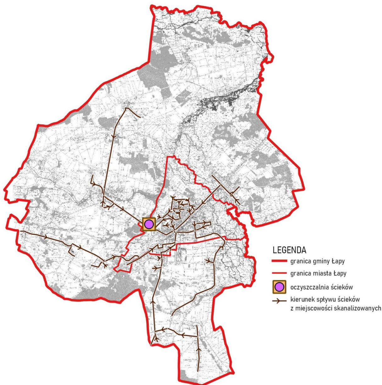
Rycina nr 18. Schemat istniejącej sieci kanalizacyjnej
